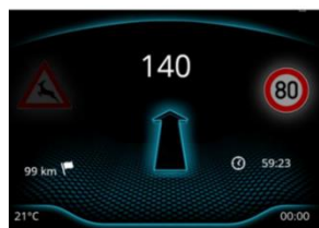
「Traveo II-C」に実装された「CGI Studio」で作成されたフルバーチャルインストルメントクラスター（左）と湾曲状のデュアルヘッドアップディスプレイ（右）
